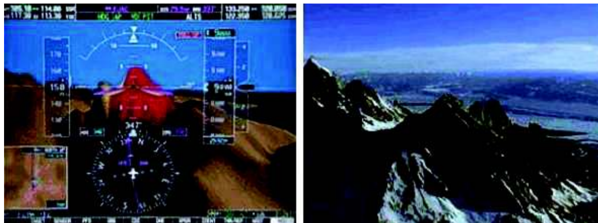
FIGURA 2 - Synthetic Vision Technology-SVT (tecnologia de visão sintética).(DEFESANET, 2011)
