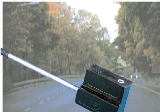
**FIGURA 03** - Equipamento DRS511/DRS511B – Fabricante VAISALA.
