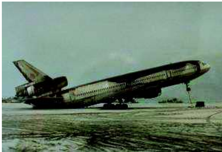
FIGURA 3 - DC-10 após encontro com cinzas do vulcão Pinatubo.
