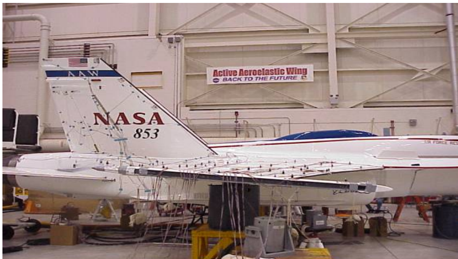
FIGURA 4. F/A-18A Hornet, AAW em testes (Adaptado de DFRC 2 , 2001)
