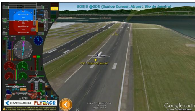
Fig. 5 –Trajetória da aeronave sincronizada com “callouts” do SOP; visão externa.
