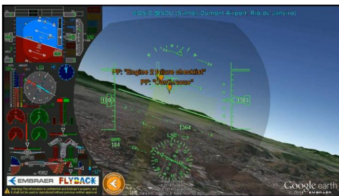
Fig. 6 –Trajetória da aeronave sincronizada com “callouts” do SOP; visão interna.
