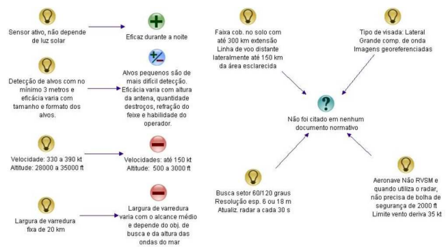
Fig. 4. Extrato de um dos mapas cognitivos, onde se destacam os pontos em vermelho e azul, que apontam discrepâncias nas normas de busca. Para maior detalhamento, sugere-se consultar a referência indicada Fonte: Leite (2013).
