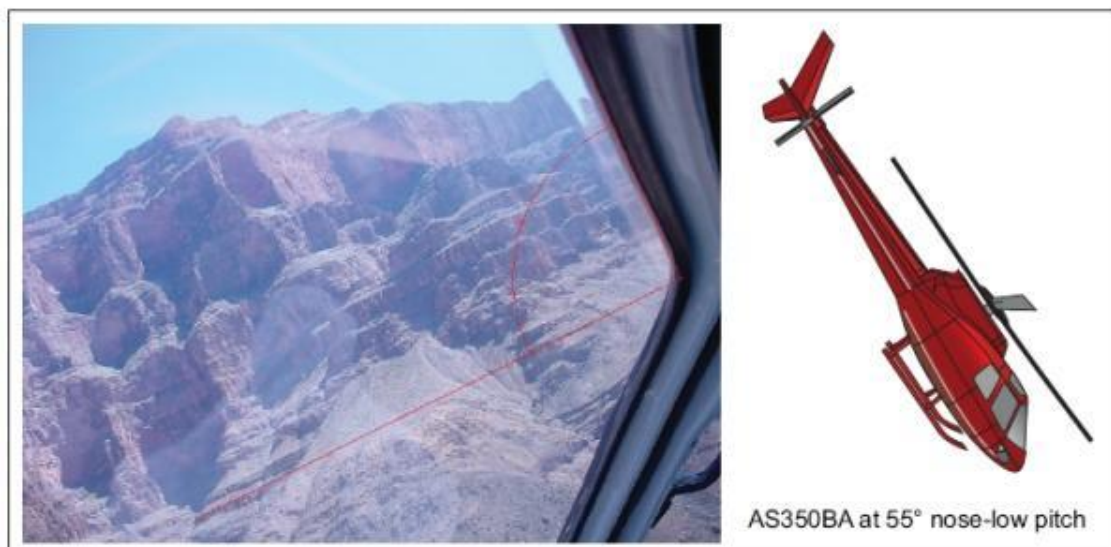
FIGURA 3: Fotografia indicando o helicóptero com uma inclinação frontal de 55 graus e um gráfico exibindo uma aeronave AS350BA com mesma atitude (NTSB, 2003).
