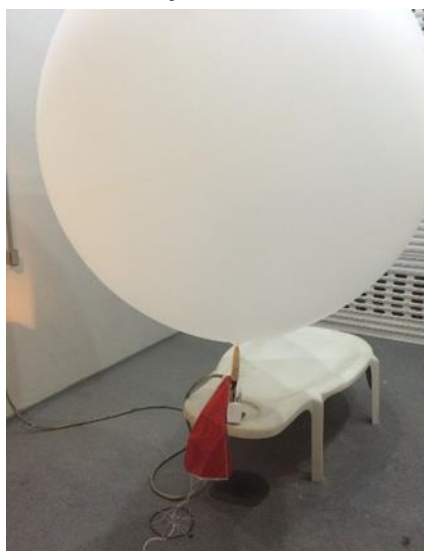
Figura 2 - Conjunto de Voo (Balão Meteorológica + Sonda). Fonte: Os autores (2017).
