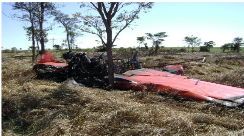
Figura 2 – PT-URR após colisão com fio (BRASIL, 2008b)
