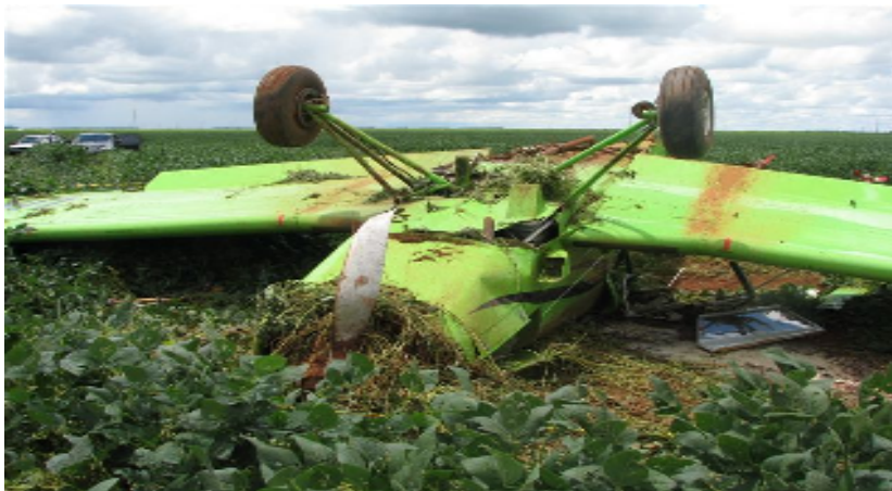
Figura 5 – PT-UKA após a colisão com a cultura (BRASIL, 2009b)
