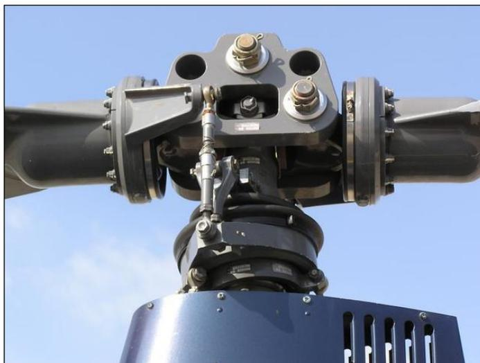
**Figura 6** – Cubo do rotor de um R22 (Fonte: QORA, 2017)
