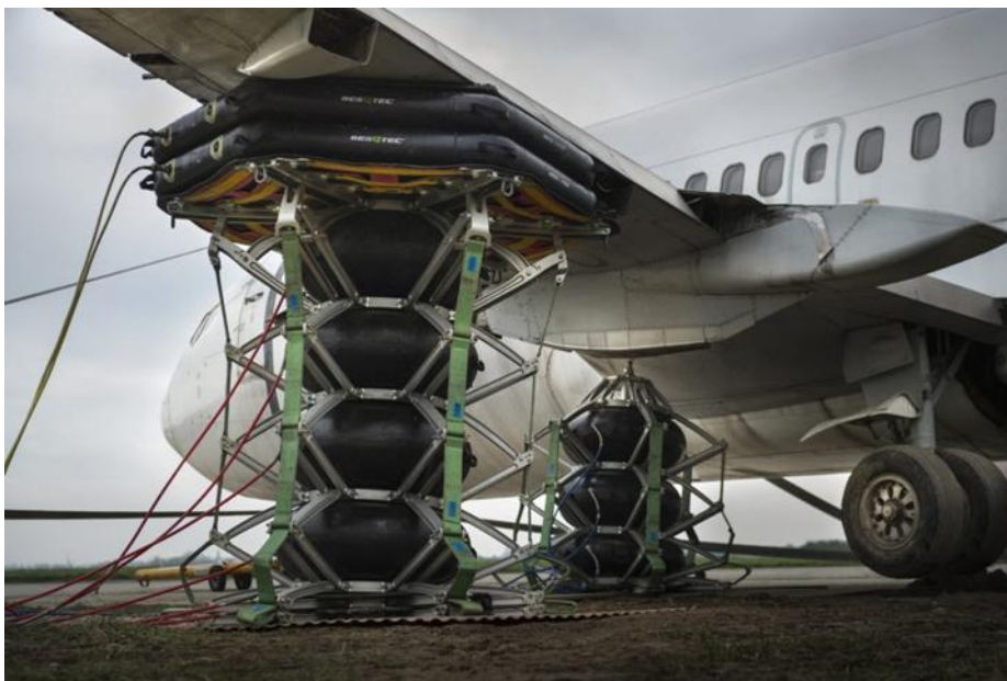
Figura 9: Elevação utilizando equipamento pneumático Fonte: RESQTEC
