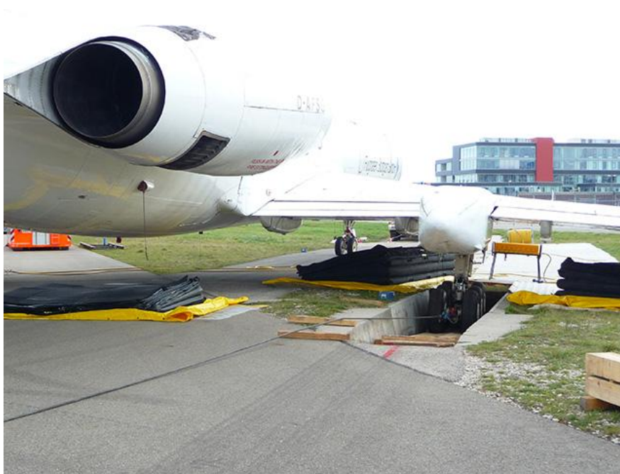
Figura 13 - Procedimento para retirar aeronave em situação Debogging
