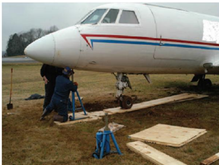
Figura 8: Elevação utilizando equipamento hidráulico.
