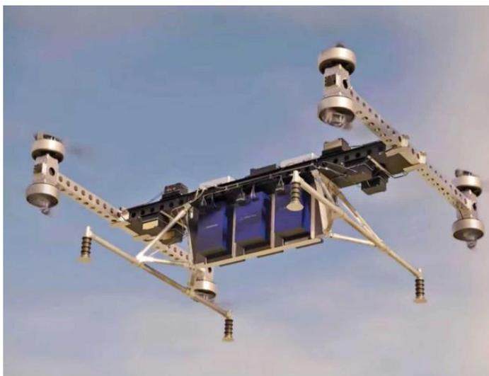
**Figura 1.2** – Drone protótipo da Boeing, para transporte de carga (MEDIUM, 2018)
