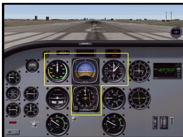
Figura 04: “T” Básico dos Instrumentos de Voo Fonte: Adaptado de Microsoft (2004)
