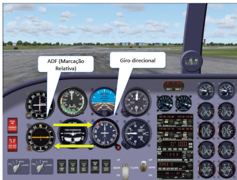
Figura 11: ADF e Giro Direcional Fonte: Adaptado de Microsoft (2004)
