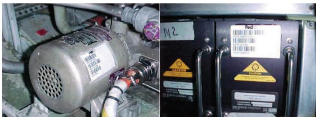
**Figura 4:** Exemplos de Etiquetas RFID Afixadas em Componentes Aeronáuticos (Raimundo Paulo, 2007).
