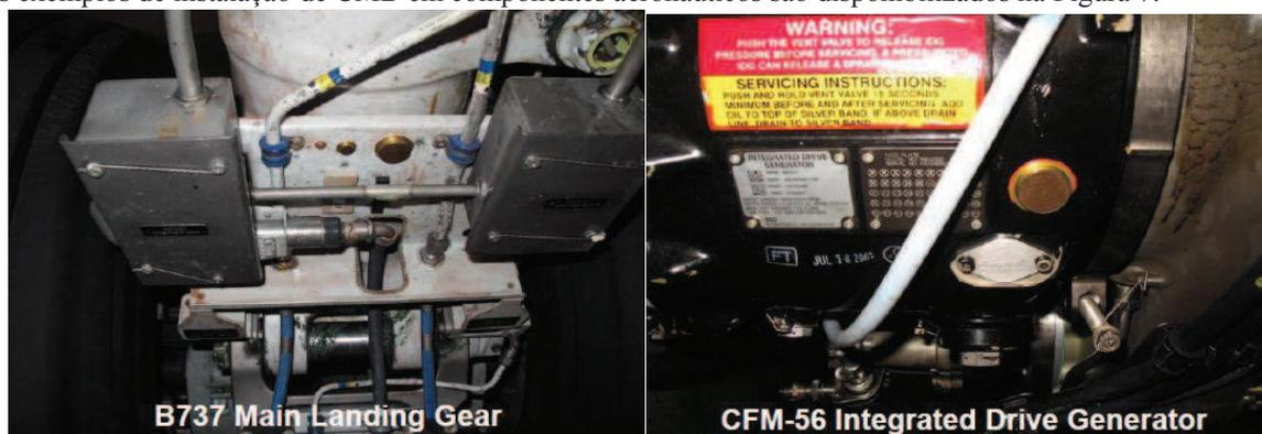
Figura 7: Exemplos de Instalação de CMB em Componentes Aeronáuticos (Kumar & Coop, 2012).
