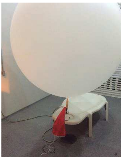
Figura 2 - Conjunto de Voo (Balão Meteorológico + Sonda). Fonte: Os autores (2017).
