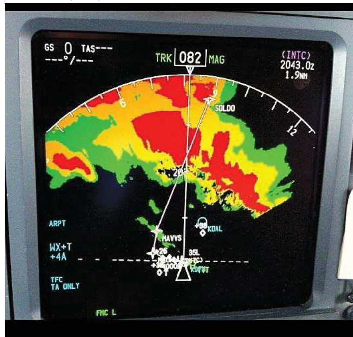
Figura 8: Formações meteorológicas exibidas pelo radar de bordo de uma aeronave comercial (MANNO, 2013).
