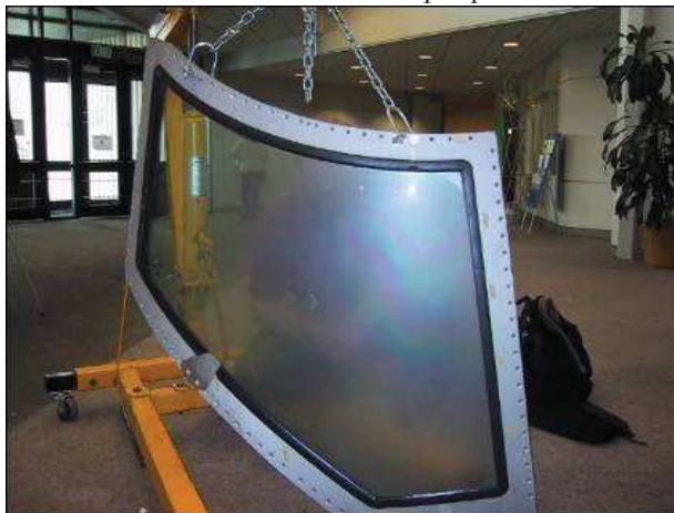
Figura 4 - Janela de cockpit erodida durante o voo por partículas de cinza (SERVRANCKX, 2016).
