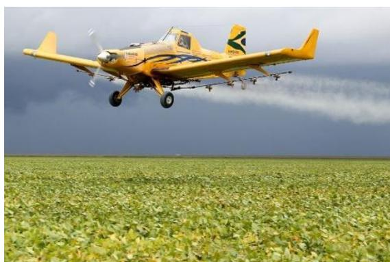
**Figura 7:** aeronave EMB-202A/ IPANEMA, Aero agrícola, Serviço Aéreo Especializado – SAE-AG [SAE Aero agrícola]
